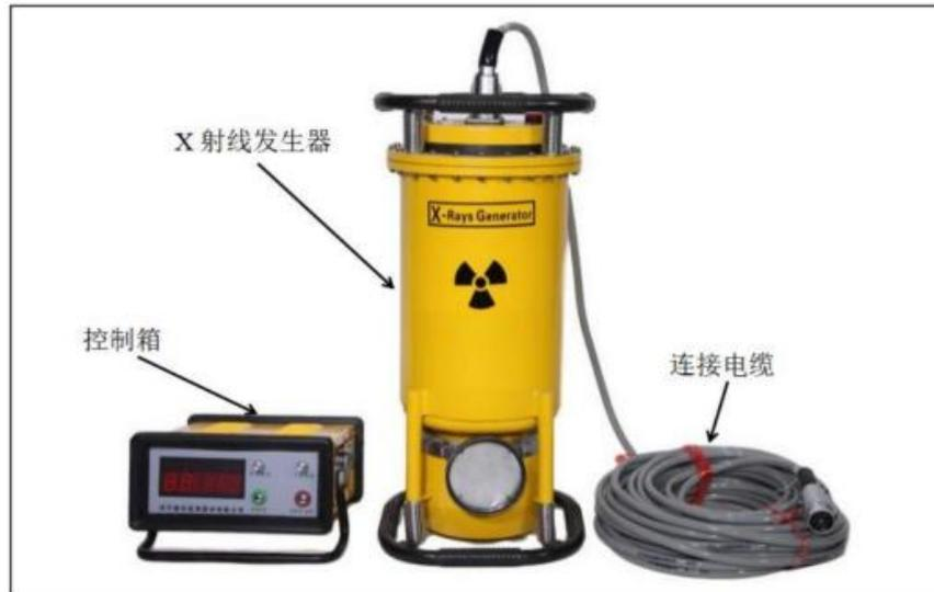
图 9-1 常见的 X 射线探伤机控制箱及发生器和电缆示意图
